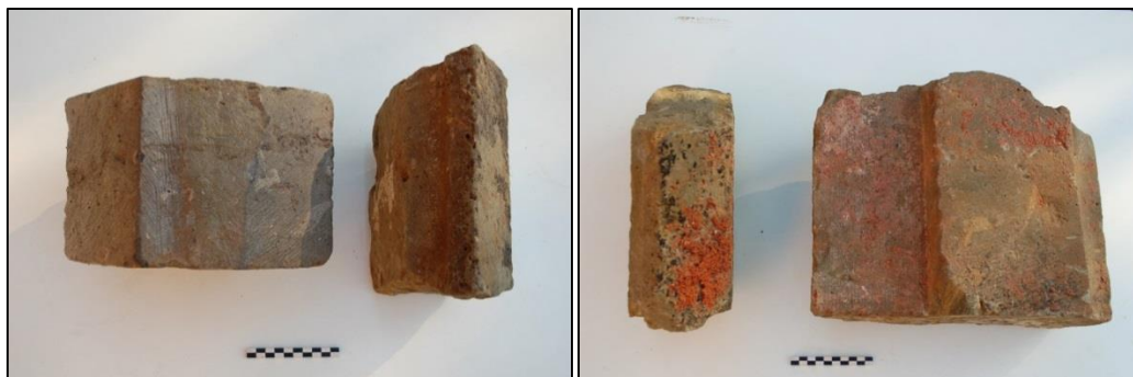
FIG. 42 Profielen in Ieperiaan kalksteen.
